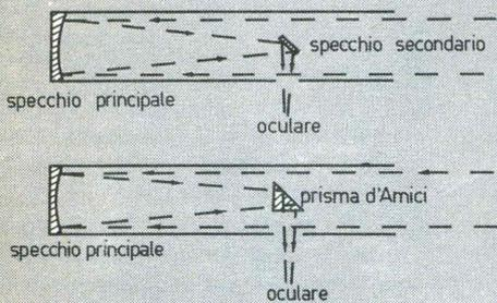
stesso telescopio con il prisma d'Amici al posto dello specchio secondario
