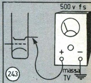
Se tutti questi controlli hanno dato buon risultato, occorre provare a sostituire il tubo RC.
