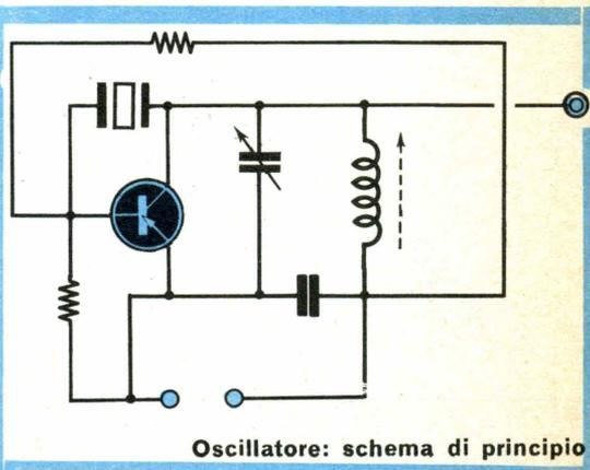
Oscillatore: schema di principio
