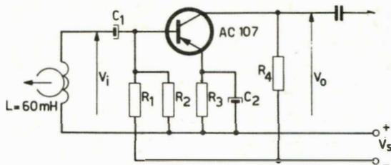
Schema elettrico del preamplificatore per magnetofoni, alimentato con  $V_s = 19\text{ V}$
