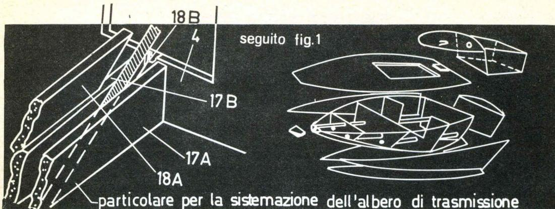
gli una inclinazione come da disegno (particolare della fig. 1), quindi fissate i pezzi 17A, 17B, 18A e 18B, avendo cura che l'albero di trasmissione non abbia giochi eccessivi.
