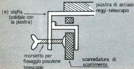
sistema di frenaggio della rotazione del telescopio
