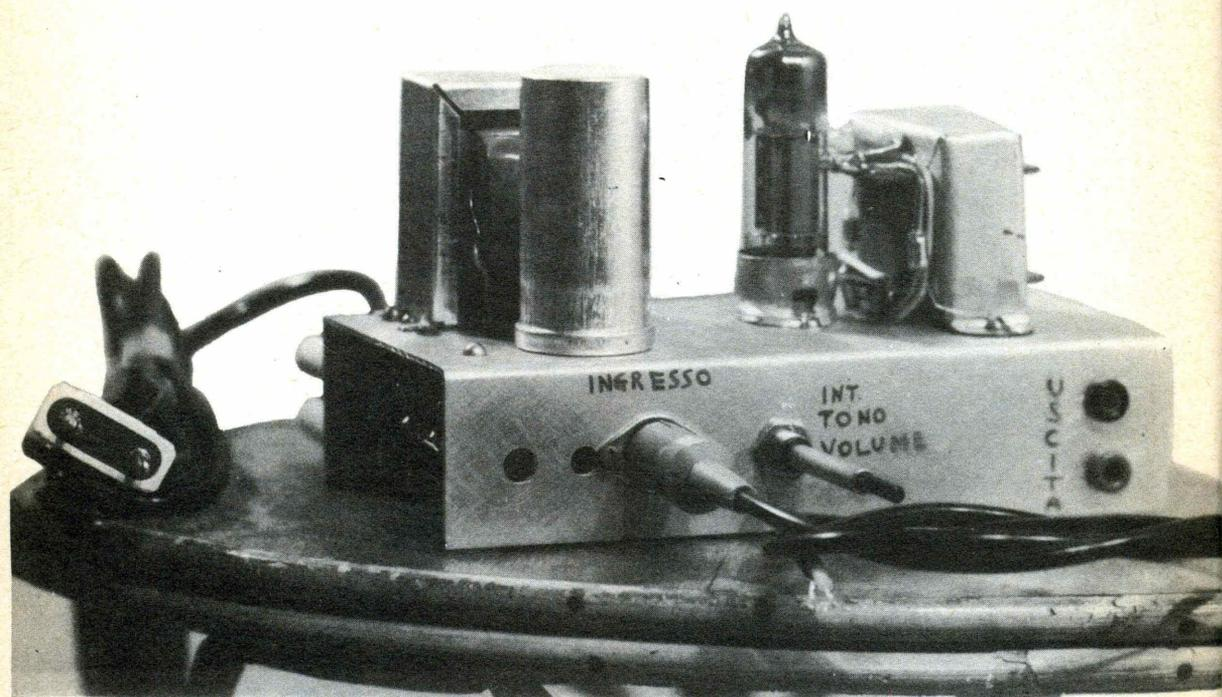
Spesso è utile disporre in laboratorio di un amplificatore di potenza, compatto e versatile.
